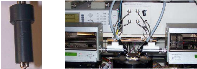
Figure 2 : Photographies d'une sonde de puissance et intégration de 2 sondes au banc de mesures
